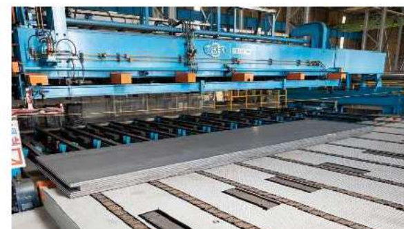
パイラー（製品集積部）
